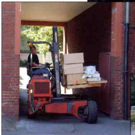
Damit der komplette Bausatz reibungslos an Ort und Stelle kommt, verfügt Weka über LKWs mit integriertem Gabelstapler, die mit Längs- und Querlauf auch enge Passagen meistern
